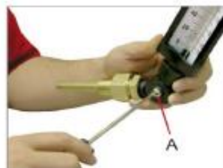
轉緊一字螺絲(A)鎖定角度
